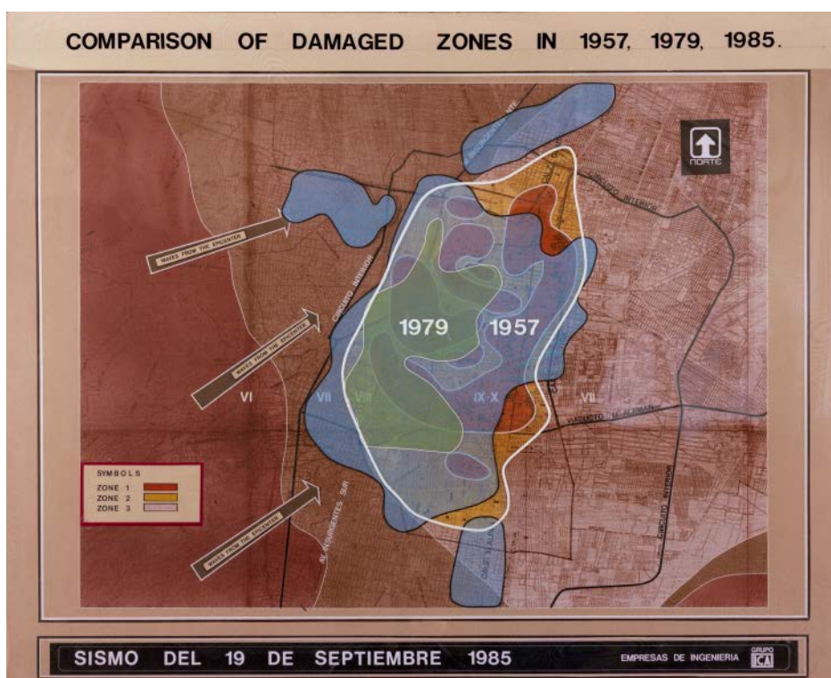
Imagen 115: Comparativa de zonas de daños en sismos de 1957, 1979 y 1985. Fuente: Fundación ICA 2020.
