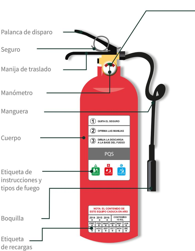
Manómetro indica la presión del extintor
